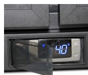
Protection de thermostat
