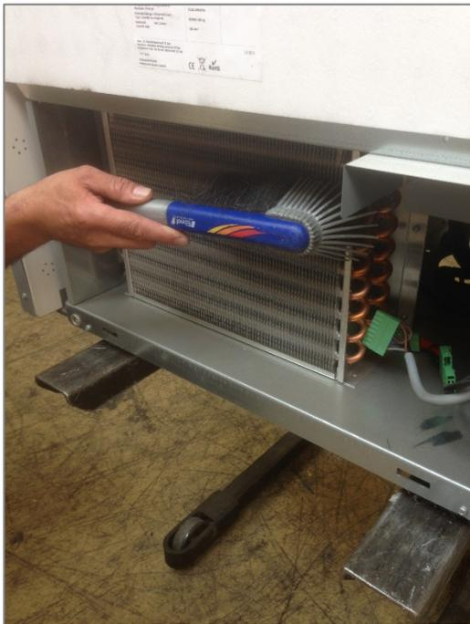
**Kondensator mit einer weichen Bürste (oder alternativ mit einem Staubsauger) vom Schmutz befreien.**
