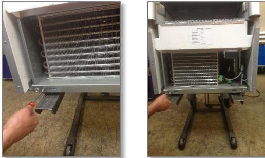
Falls zum Kondensator auch der Abfluss gereinigt werden soll, müssen die beiden Schrauben oben am Aggregat gelöst werden.
